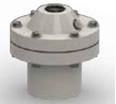
Для жидкостей, содержащих частицы во взвешенном состоянии или которые несут ответственность кристаллизации, могут быть изготовлены с промежуточной камерой, содержащей диафрагму, через которую изменение давления линии, передается на сигнализатор. Преимущество промежуточной камеры в том, что она имеет большие и меньшие ограничения площади поверхности, открытые на линии жидкости, тем самым значительно снижая вероятность засорения.
